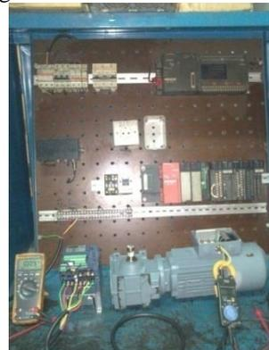
Gambar 8. Simulasi Sistem Motor Induksi 3 Fasa Penggerak *Transferring*
