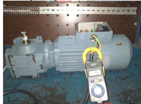
Gambar 7. Pengukuran Arus Motor Induksi Penggerak *Transferring*
