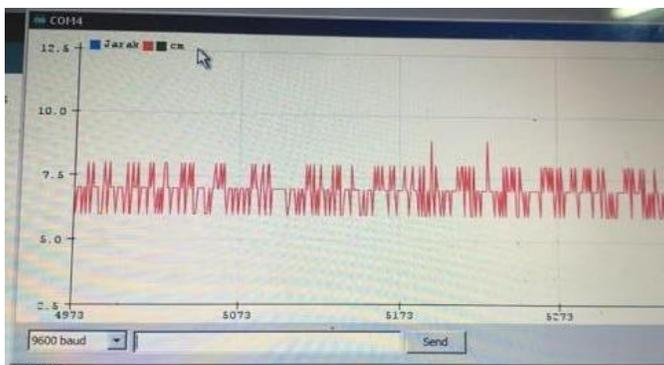
Gambar 16. Grafik kesetimbangan pada putaran poros 1420 rpm
