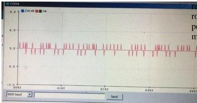
Gambar 14. Grafik kesetimbangan pada putaran poros 1031 rpm
