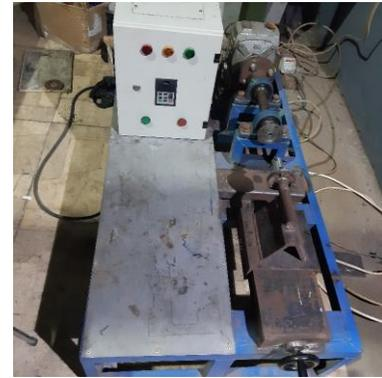
**Gambar 1.** Pengujian Puntir
