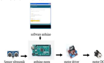
Gambar 1. Susunan alat gerak robot pembersih lantai
