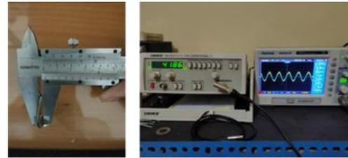
Gambar 9. Hasil pengukuran frekuensi dengan ring Ø26 x 1,6mm
