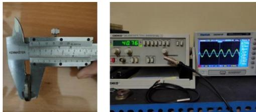
**Gambar 12.** Hasil pengukuran frekuensi dengan ring Ø26 x 3,6mm
