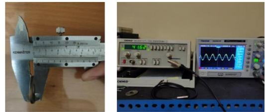
**Gambar 14.** Hasil pengukuran frekuensi dengan ring Ø26 x 2,3mm
