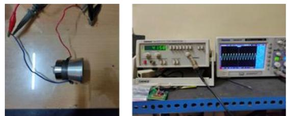
**Gambar 6.** Pengukuran frekuensi *ultrasonic* transduser
