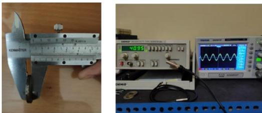
**Gambar 13.** Hasil pengukuran frekuensi dengan ring Ø26 x 3,3mm
