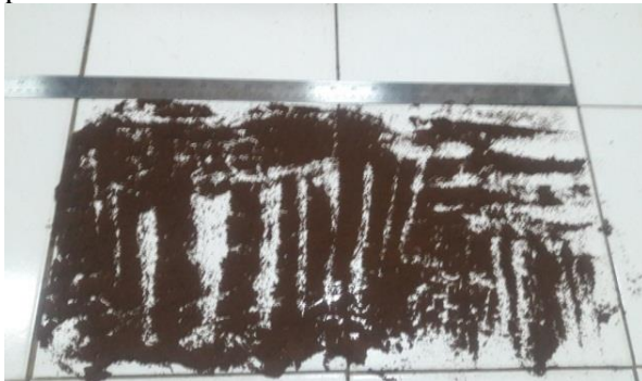
Gambar 4. Debu (serbuk kopi) yang ditebar untuk pengujian
