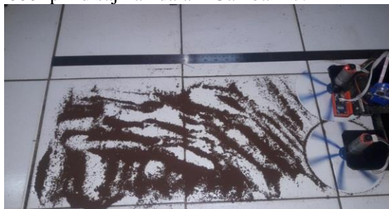
Gambar 5. Proses Penyedotan Debu (Serbuk Kopi) pada putaran 1000 rpm
