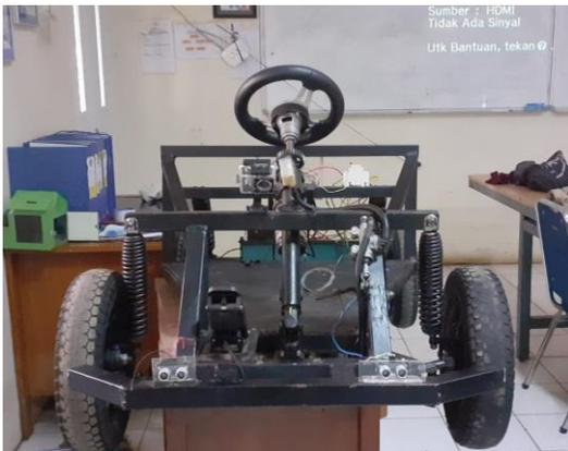
**Gambar 9.** Rancangan mobil listrik otonom bagian depan
