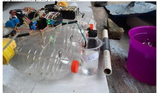
Gambar 4. Hasil pengujian soil moisture sensor dengan objek air
