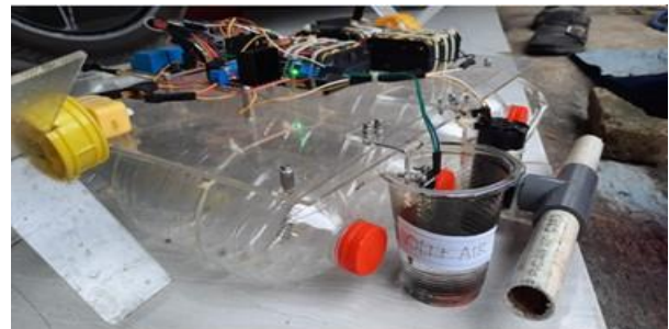
Gambar 8. Hasil pengujian soil moisture sensor dengan objek oli/pelumas + air
