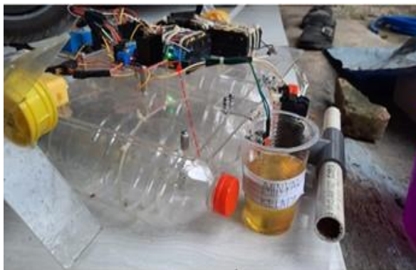
Gambar 3. Hasil pengujian soil moisture sensor dengan objek minyak
