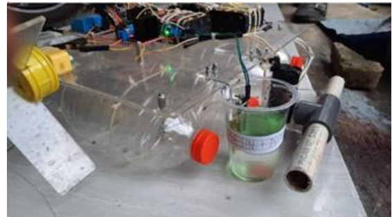
Gambar 6. Hasil pengujian soil moisture sensor dengan objek bensin + air
