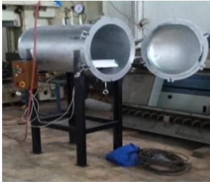
**Gambar 2.** Hasil rancang bangun heater pada oven autoclave
