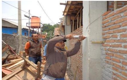
Gambar 9 Uji *hammer test* kolom eksisting
