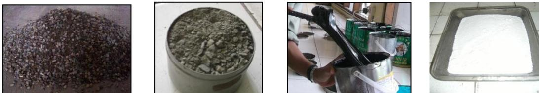
Gambar 1 Agregat Kasar, agregat sedang, agregat halus dan aspal pen 60/70 Pertamina
