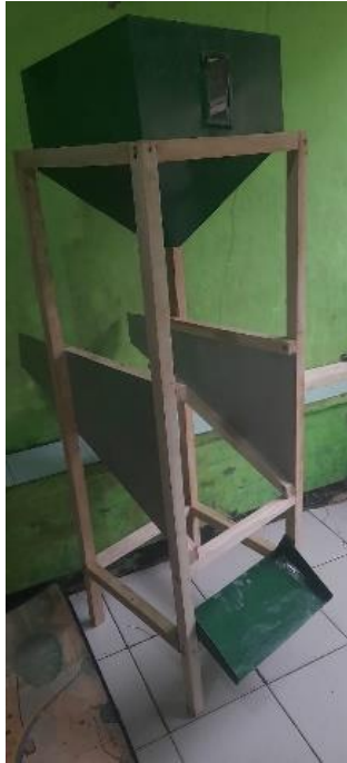
Gambar 1. Rangka & hopper besi Gambar 2. Desain Mekanik Mesin Pemisah Gabah
