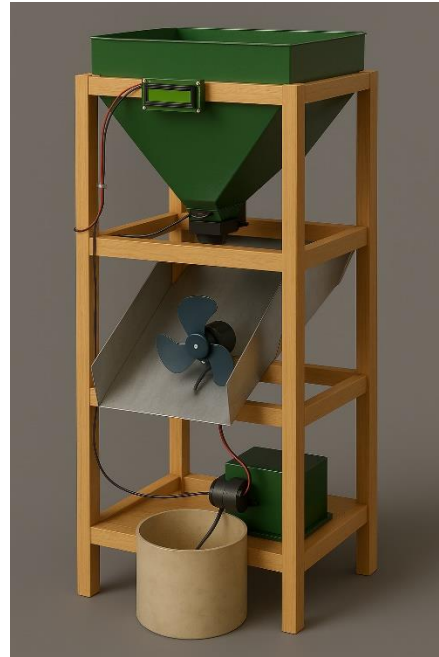
Gambar 1. Rangka & hopper besi Gambar 2. Desain Mekanik Mesin Pemisah Gabah
