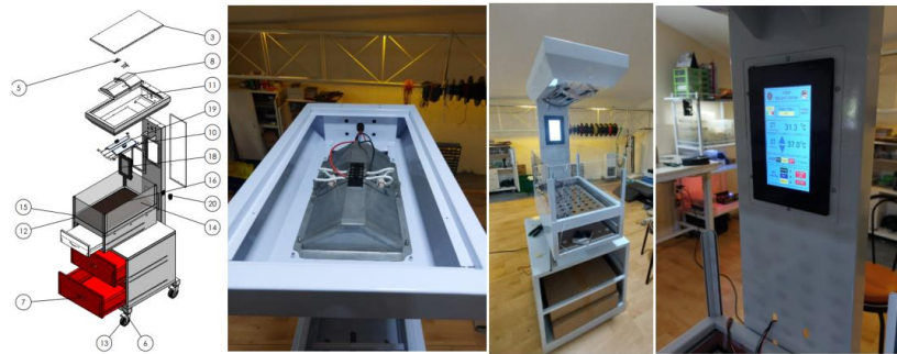
Gambar 2. Prototipe perangkat keras infant warmer dan sistem pengendaliannya
