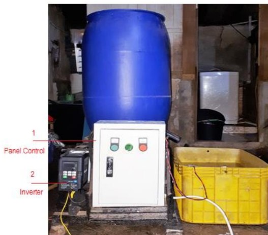
Gambar 5 Bentuk Fisis Alat Penyaring Ampas Kedelai
