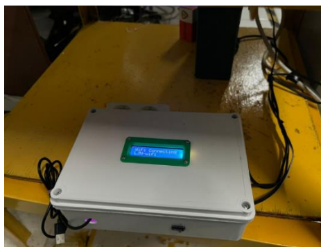
Gambar 3. Pengujian Monitoring PLTS dan PLTA Berbasis IoT
