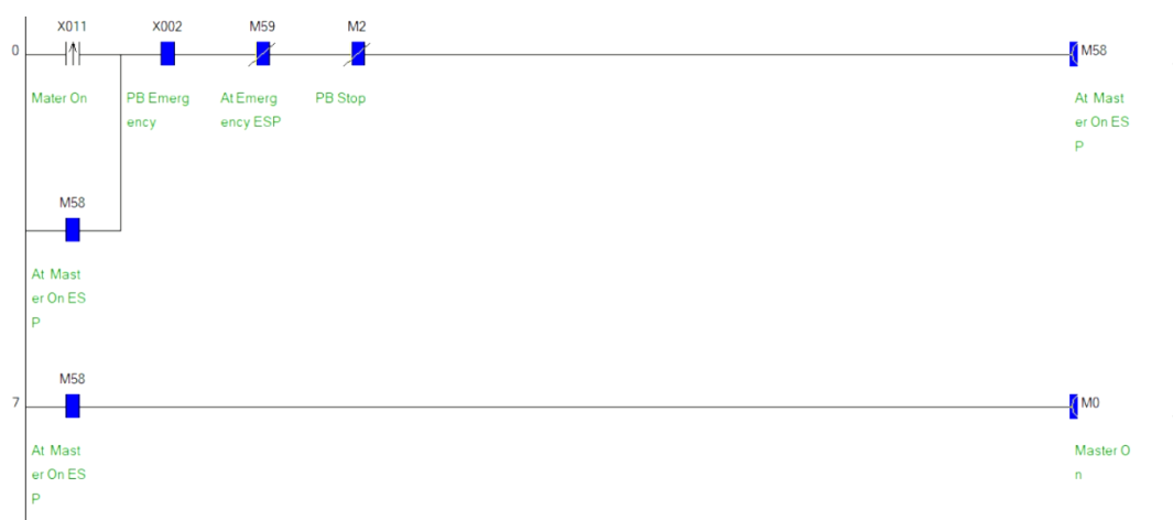
Gambar 9 Program Master ON Input Dari Esp Lewat Relay
