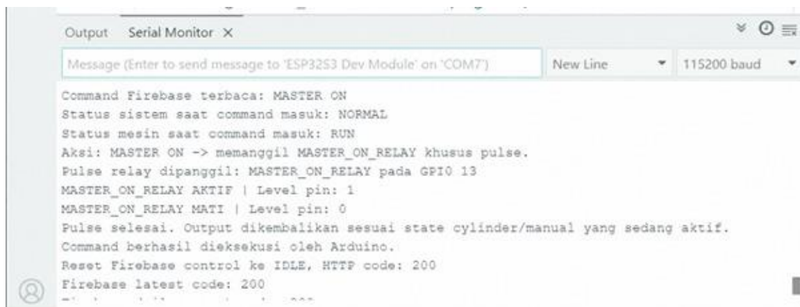
Gambar 8 Serial Moniitor ESP Ketika Mengirimkan Input Ke Plc Lewat Relay Mode Otomatis
