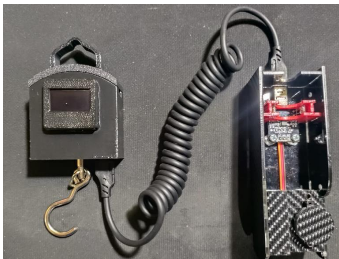
Gambar 3. Bentuk fisis prototipe sistem monitoring dan kendali infus
