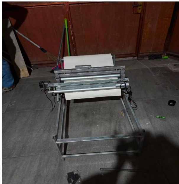
Gambar 2. Hasil perakitan keseluruhan mesin Cut to Length
