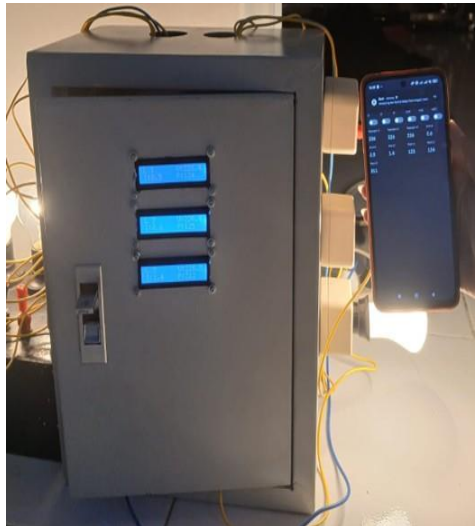
Gambar 4 Tampilan sistem saat pengukuran kinerja pengendali beban listrik fase-tunggal tiga jalur
