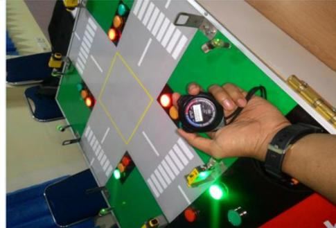
Gambar 19 *Verifikasi* Waktu PLC Dengan *Stopwatch*
