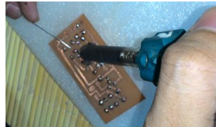
Gambar 9 Penyolderan pada modul transmitter
