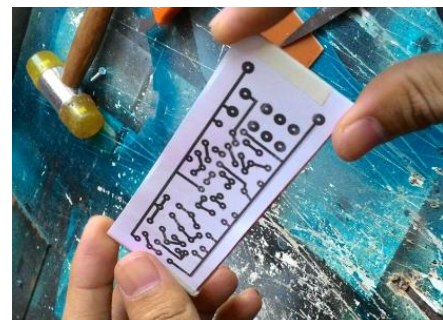
Gambar 4 PCB yang telah dirancang berdasarkan gambar rangkaian
