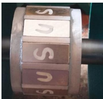
Gambar 5 Penempatan magnet permanen pada rumah magnet di inti poros rotor
