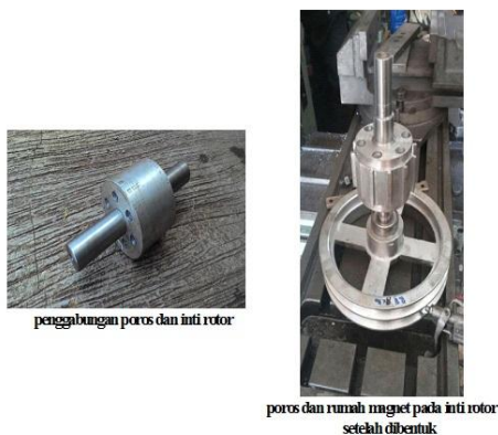
Gambar 4 Bentuk fisik poros dan alur magnet pada inti rotor
