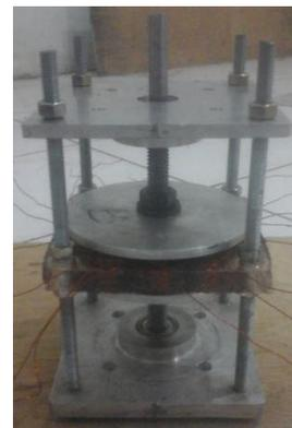
Gambar 4.1 Generator yang telah dibuat
