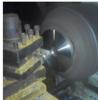
**Gambar 3.1** Pembuatan *Flange* Rotor menggunakan
