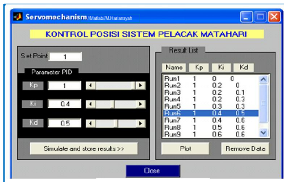
Gambar 6 Tampilan GUI simulasi sistem deteksi arah sinar matahari
