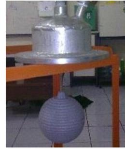
Gambar 11 Pemasangan batang penghubung dan pelampung
