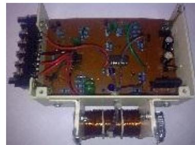
Gambar 16 Pengintegrasian transformator dan rangkaian penguat
