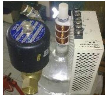
**Gambar 19** Penempatan *LVDT* sebagai alat ukur
