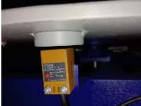
Gambar 3.15 Sensor proximity counter ketika mendeteksi logam pada meja pembungkus
