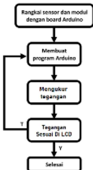
Gambar 1 Diagram Alir Perangkat Lunak
