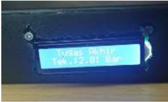
Gambar 11. Nilai Tekanan pada LCD sesudah memutar adaptor kepala tabung
