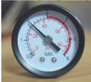
Gambar 12. Nilai Tekanan pada manometer sesudah memutar adaptor kepala tabung
