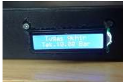
Gambar 9. Nilai pengukuran pada LCD sesudah merubah nilai offset
