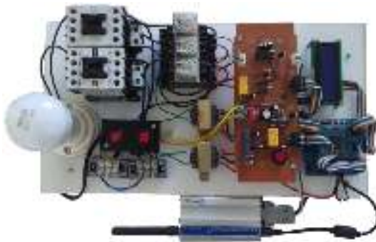
Gambar 4. Prototipe AMF dan monitoring genset via SMS berbasis mikrokontroler Atmega 128
