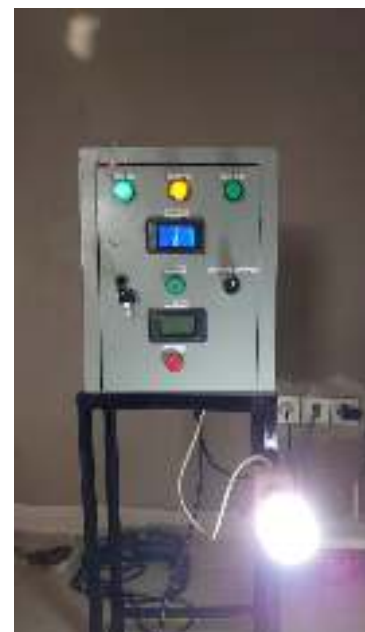
Gambar 3.3 Pengujian Beban Dengan 1 Lampu LED 15W
