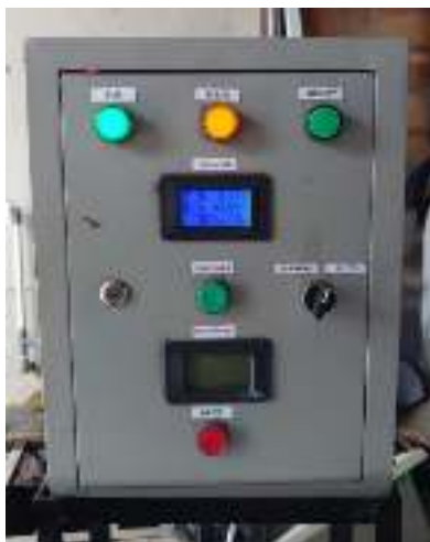
Gambar 3.1 Tampilan Panel Ketika Suplai Daya dari PLN
