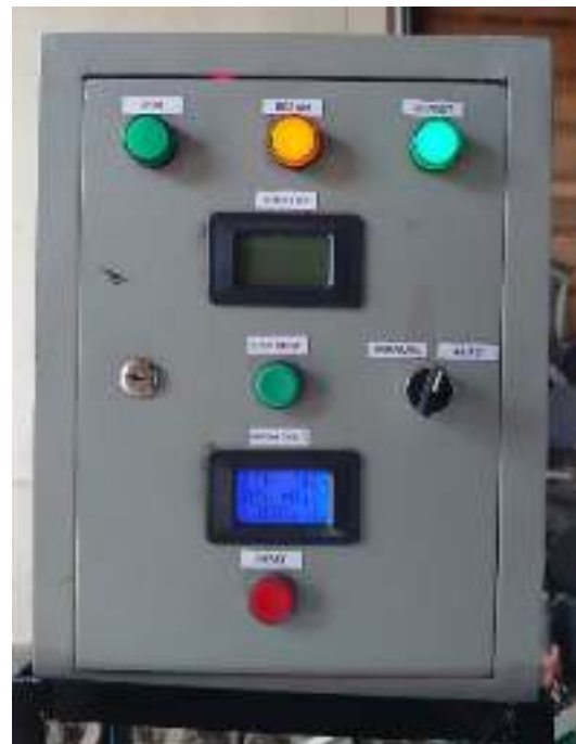
Gambar 3.2 Tampilan Panel Ketika Suplai Daya dari Genset
