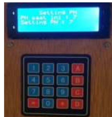
Gambar 11. Tampilan keypad untuk setting pH meter dan pompa air
