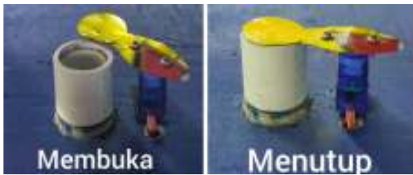
Gambar 9. Bentuk fisis motor servo saat membuka katup dan menutup katup
