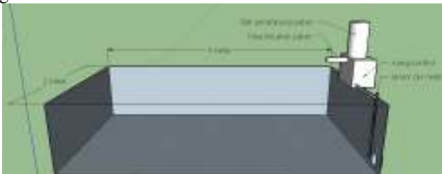
Gambar 3. Disain rancang bangun sistem monitoring kadar pH air kolam dan pemberian pakan secara otomatis
