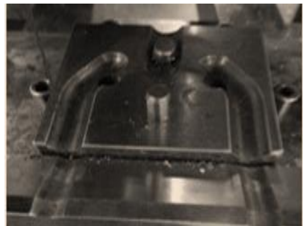
Gambar 4. Terdapat burry sisa potong material
