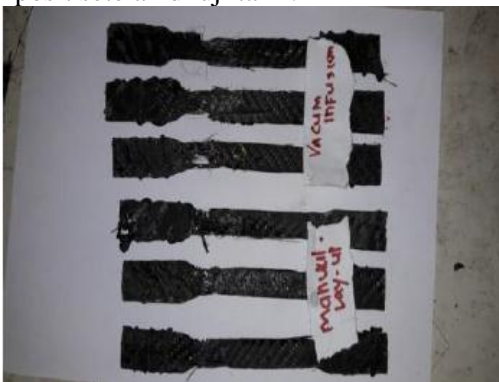
Gambar 5 spesimen setelah uji tarik
