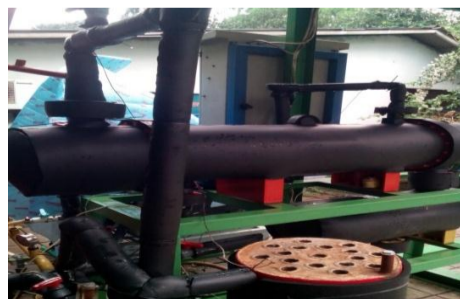
Gambar : ORC Solar Kolektor dengan material Polyurethane (Warna hitam)
