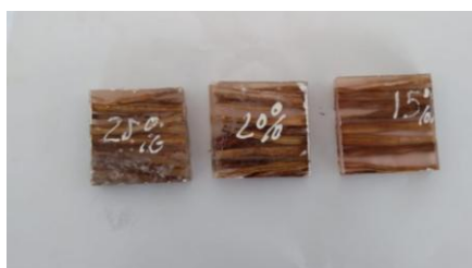
Gambar 5. Sampel Uji Daya Serap Air Laut
