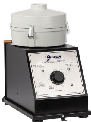
Gambar 2. Alat Ekstraksi Sentrifugal (ASTM D2172)
