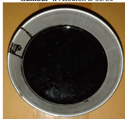
Gambar 5. Bitumen Asbuton B 50/30
