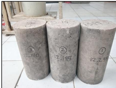
Gambar 5. Sampel Beton Siap Uji
