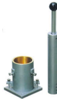
Gambar 3 Alat Pengujian Kepadatan Proctor Standar, cetakan dan pemukul (sumber: Dokumentasi Lab.Mekanika Tanah)
