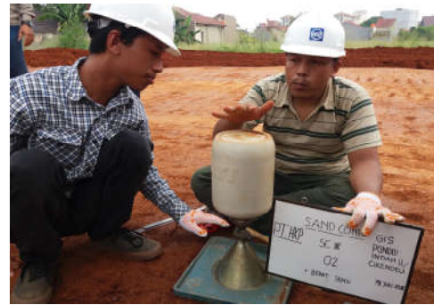
Gambar 2 Prosedur pengujian Konus Pasir (sumber: Dokumentasi Lab.Mekanika Tanah)
