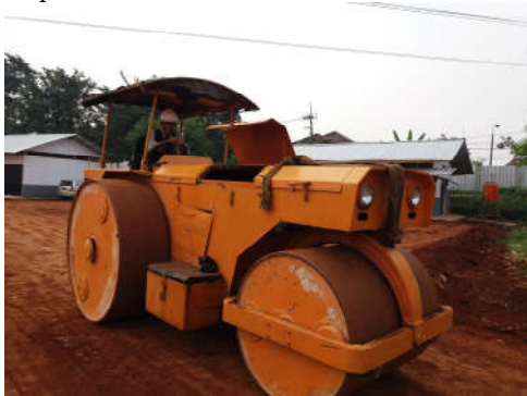
Gambar 4 Alat pemadat Tandem Roller (sumber: Dokumentasi PT. HKP, 2018)
